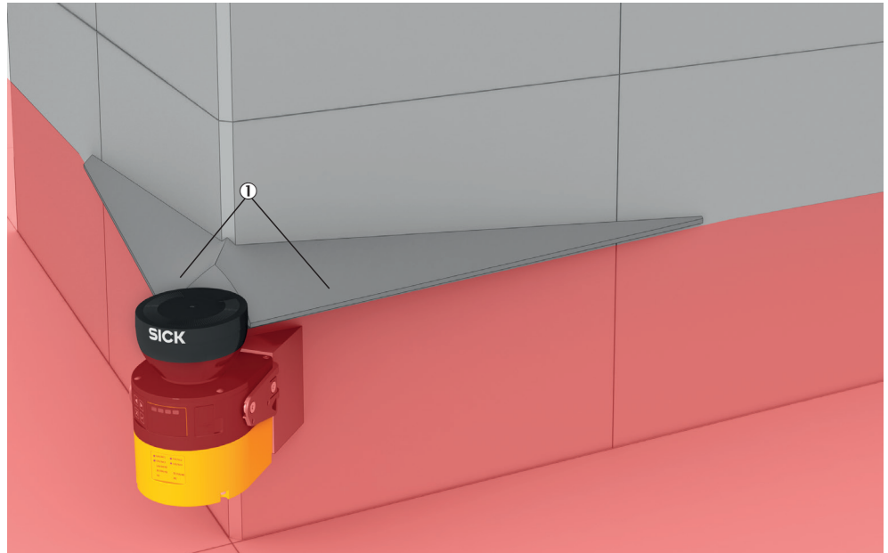
插图 19: 利用折向板安装 (示例)
